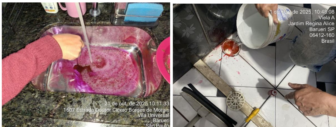
Figura 49: Teste de corante utilizado na fiscalização do lançamento de esgoto sanitário
