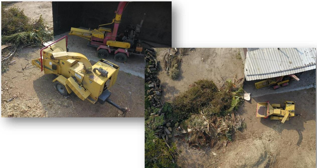
**Imagem 9 e 10:** À esquerda, máquinas trituradoras onde são inseridos os resíduos verdes de poda e corte da manutenção urbana. À direita, material orgânico antes da trituração.
